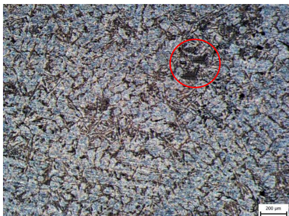
Obr. 26: Intermetalická fáze Al_{15}(Fe,Mn)_3Si_2 (čínské písmo; rybí kost), zvětšení 63x
