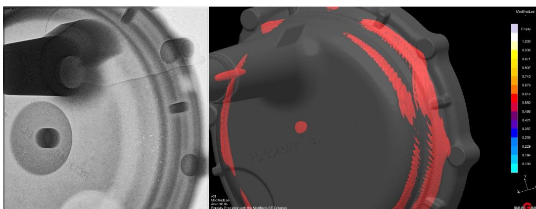
Obr. 5: RTG snímek skutečného odlitku a porovnání výsledků simulace. Pro vyhodnocení výskytu mikroporozity používáme kritérium „modified Lee“, které velmi dobře vystihuje realitu.
