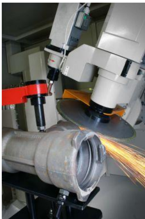
Obr. 21: Hlavní broušící kotouč a uchycení odlitku
