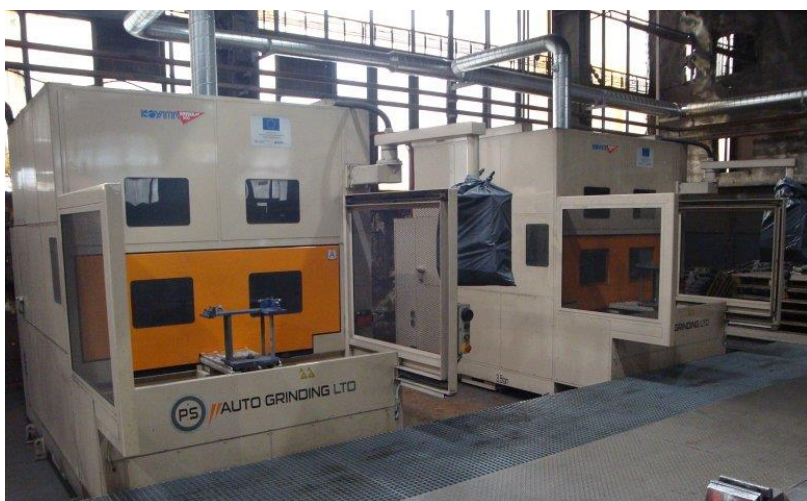
Obr. 22: Brousící zařízení Koyama ve slévárně GIFF a.s.
