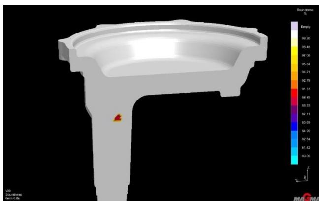
Obr. 9: Zobrazení výskytu staženiny na svislém řezu středem odlitku
