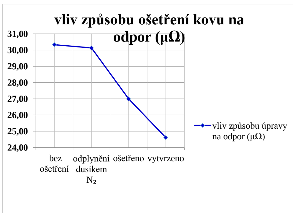
Obr. 17: Vliv způsobu ošetření kovu na odpor
