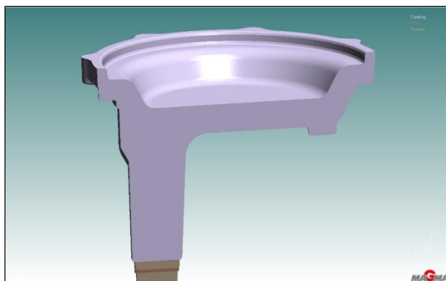
Obr. 7: Svislý řez středem geometrie s širokým dnem
