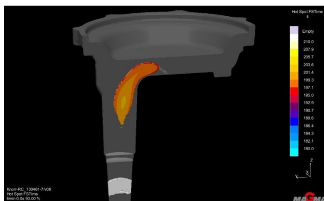
Obr. 8: Zobrazení teplotního uzlu na svislém řezu středem odlitku
