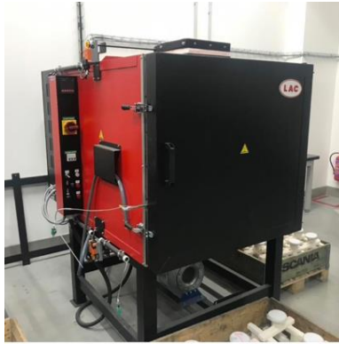
Obr. 7 Pec na TZ Mg odlitků
