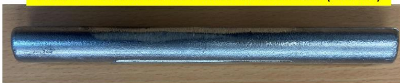
PŘEDLITÝ POLOTOVAR PRO VÝROBU ZKUŠENÍ TYČKY (VZORKU)
