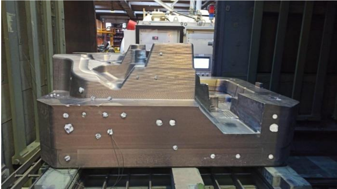
Obr. 17: Příklad zakládání formy na kalení včetně uložení termočlánků T_s a T_c (MCS Facchetti, https://www.mcsfacchetti.it/ ) [7]
