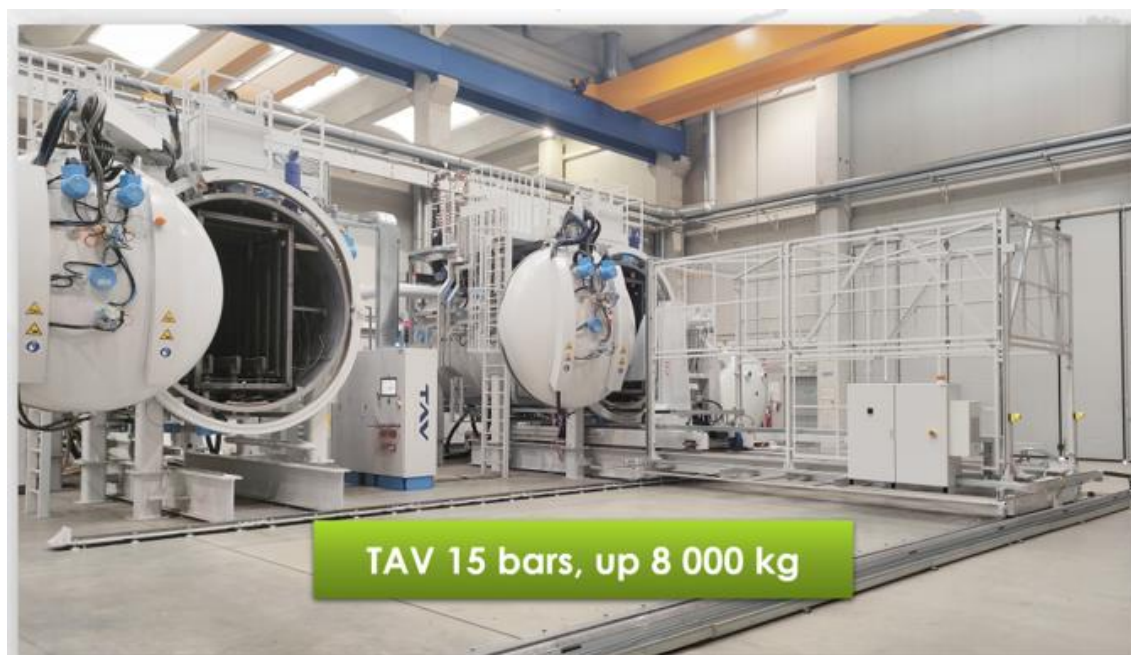
Obr. 16: Vakuová pec TAV Vacuum Furnaces H12-S, 1500x900x1500 mm pro GIGA Tools, na 15 bar přetlaku a do 8 000 kg [7]
